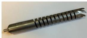
Utensile per la rimozione del foglio di alluminio
