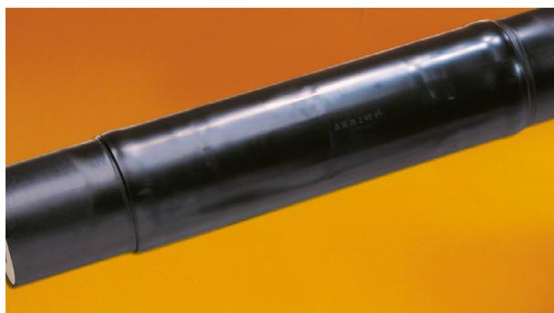
Giunto installato correttamente: i segni poligonali di espansione sono scomparsi e le estremità termoretraibili sono piatte e lisce.
