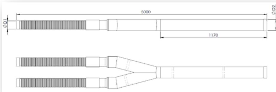
Unsere vernetzten Mantelverbindungen können standardmäßig das Gehäusemaß reduzieren, wenn die an das Zusammenführungsrohr angeschlossenen AluFlextra unterschiedliche Mantelmaße aufweisen.
