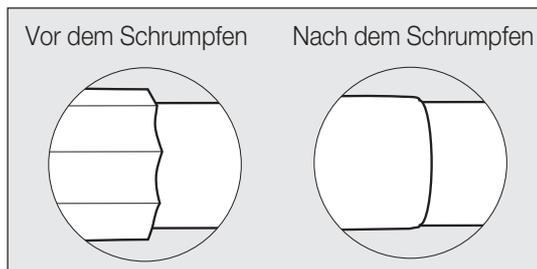
11. Schrumpfen bis die Aufweitungsstellen verschwunden sind, und das Muffenende eine fast gerade, umlaufende Kante bildet.
