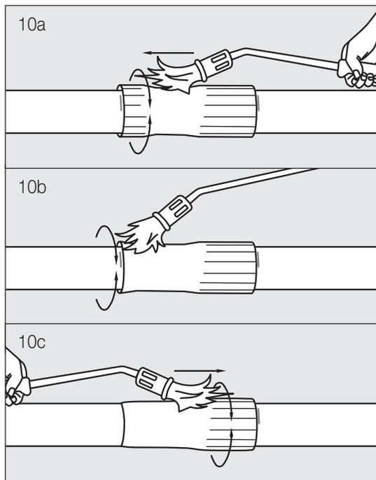
10. Die Verpackung der Schrumpfmuffe entfernen. Sicherstellen, daß die Muffe außen und innen SAUBER und TROCKEN ist. Muffe über der Verbindungsstelle anbringen und die Position markieren. Zuerst von der Mitte gegen eine Seite schrumpfen und danach von der Mitte gegen die andere Seite schrumpfen. Nie direkt auf dem Mantel erwärmen.
