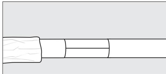
5. Dämmschalen stramm zwischen den Mantelrohren anbringen, evtl. Klebeband benutzen. Alle Oberflächen müssen SAUBER und TROCKEN sein.
