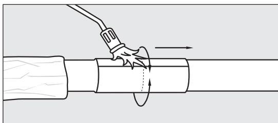
9. Folie von der Mitte gegen beide Seiten erwärmen, bis die Dichtungsmasse an allen Kanten hervortritt und die Folie um das Rohr stramm liegt.
