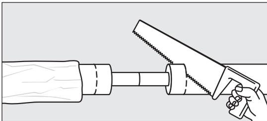
2. Den äussersten Teil der Mantelrohre bei der Markierung abschneiden.
