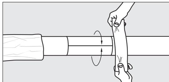
6. Mantelrohre mindestens 150 mm von beiden Rohrenden mit Schmirgelleinen, Körnung 80, schleifen.
