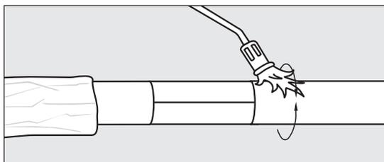
7. Mantelrohre mindestens 150 mm von beiden Rohrenden mit Gasbrenner aktivieren, bis die Oberfläche seidig glänzt.
