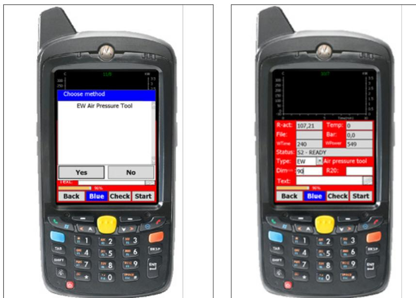
Die Dokumentation im WeldMaster wird ebenfalls aktualisiert, damit es möglich wird zu sehen, ob die Montage vom EWJoint mit dem neuen flexiblen Druckwerkzeug erfolgt ist. Siehe untenstehende Abbildung.
