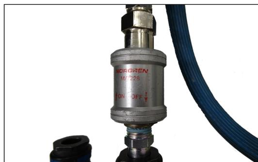
Wenn alle Schläuche verbunden sind, das Ventil öffnen, so die Druckbänder unter Druck gesetzt werden.
