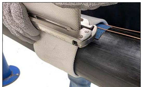
Keil zwischen Druckband und AirLock einschieben. Bitte darauf achten, dass der Keil in der Mitte des Druckbandes montiert ist.
